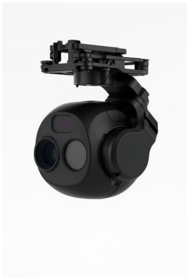
**ОЛ-ГСП-150**- это мультиспектральная оптико-электронная система на трех осевом гиростабилизированном подвесе с телевизионной и тепловизионной камерами и лазерным дальномером. Эта система предназначена для выполнения задач разведки в дневное и ночное время. Система автоматически распознает и сопровождает неподвижные и движущиеся цели, измеряет координаты целей. Подходит для малых и средних дронов, выполняющих задачи по разведке, наблюдению и патрулированию.
