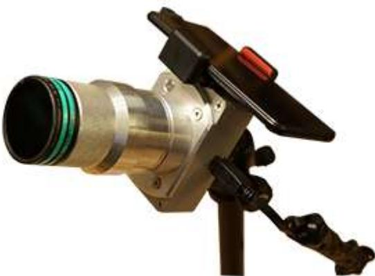
Камера ультрафиолетовая ОЛ-УФК-202 базируется на КМОП фотоприемнике, чувствительном в спектральном диапазоне 200-400 нм. Компоновка камеры оптимизирована под мобильное применение на штативе, с управлением и питанием от смартфона с ОС Android. В стандартном исполнении используется объектив ОЛ-УФ2-075-28 и фильтр на 315-360 нм. Под заказ предлагаем любые компоновки и комплектации данной камеры.
