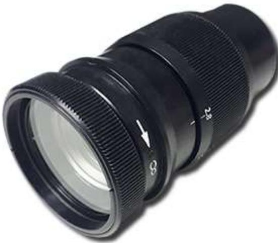
Объектив ОЛ-Т-090-28 разработан для применения в условиях повышенной влажности, брызг, соляного тумана. Герметизация выполнена по IP67, для герметизации камеры требуется уплотнение между задним фланцем объектива и корпусом камеры. Объектив снабжен регулируемой вручную диафрагмой и фокусировочным кольцом. Сменное защитное стекло обеспечивает безопасность поверхности первой линзы.
