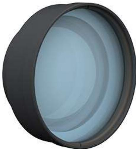
Лазерный объектив с телескопическим ходом лучей в пространстве предметов ОЛ-Л2-650-15 предназначен для использования в сканирующих лазерных системах, работающих на длине волны 405 нм. Объектив отличается большими рабочим расстоянием в 770 мм и полем сканирования 400 мм, что позволяет стоять сканирующие системы соответствующих габаритов.
