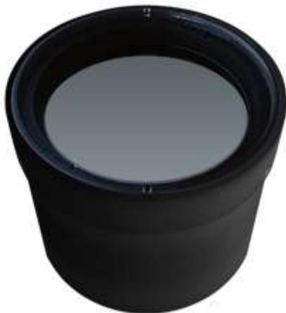
Атермальный ИК объектив ОЛ-ИК2 используется в тепловизионных камерах различного назначения, тепловизионных прицелах и приборах наблюдения, работающих в спектральном диапазоне 8-14 мкм. Объектив за счет своей конструкции не требует перефокусировки в пределах рабочих температур -40...+40 °C. Отличное качество изображения обеспечивается использованием асферической оптики.
