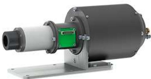
Гиперспектральная камера ОЛ-ГСК-103 представляет собой щелевую камеру, работающую в волновом диапазоне 400-760 нм. Оригинальная оптическая схема камеры обеспечивает практическое отсутствие в масштабах пикельной линии сферических (smile) и хроматических (limestone) aberrаций, что позволяет выполнять аналитические задачи без перекалибровки. Камера работает по принципу пространственного сканирования и предполагает линейное перемещение предмета (сканер, конвейер, БПЛА).
